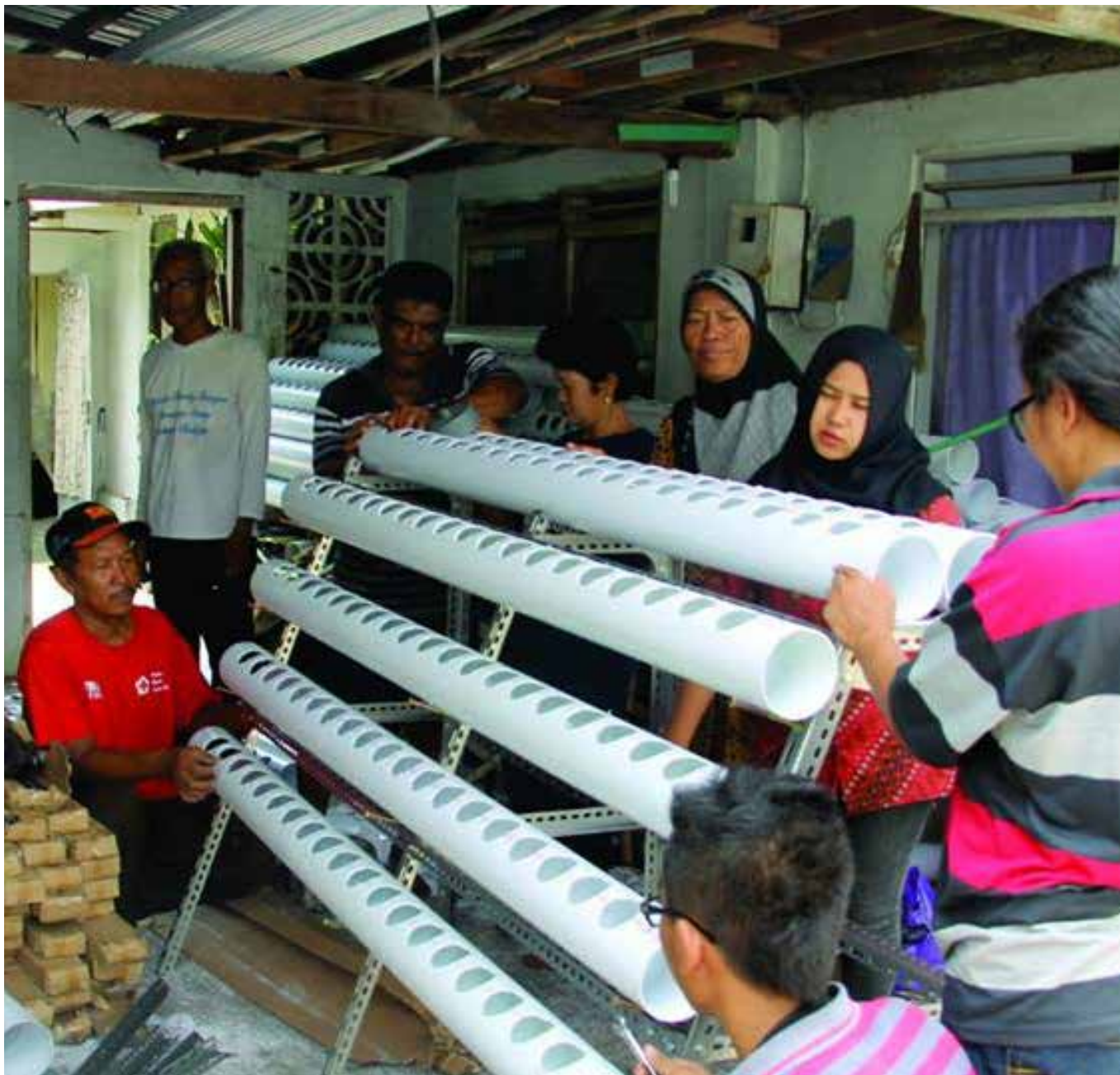
Tim SIBAT Kelurahan Sewu membuat instalasi kebun hydroponic dari bahan pipa plastik dan besi.
