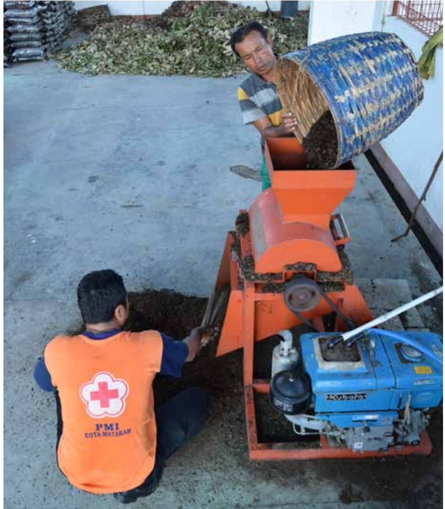
Petugas Unit Pengolahan Sampah Kota Mataram dan Relawan PMI menggunakan mesin cacah untuk menghaluskan sampah daun untuk dijadikan pupuk organik.
